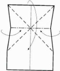
**6** Den Mittelbruch in eine TalFalte bringen. Beide Flügel müssen exakt aufeinander liegen. Für die Tragflächen parallel zum Mittelfalz innen eine Bergfalte und für die seitlichen Ruder außen Talfaltens ausführen.
